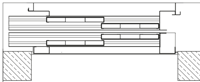
Horizontální řez kabinové a šachetní dveře s dveřní zárubní / napojení na zeď T1.
