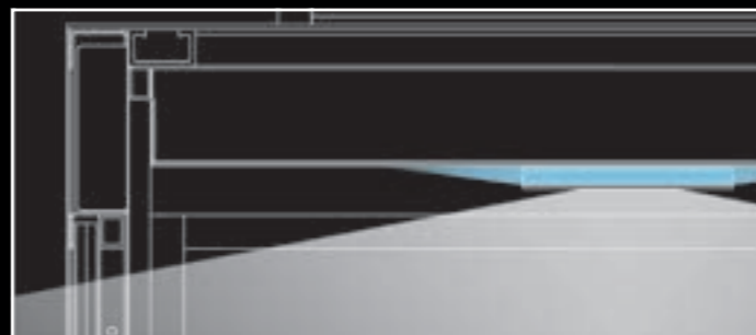
Vertikální řez LD7-LED-RGB stropní světlo Schema funkce: přímé a nepřímé osvětlení LED neutrální bílá / barva světla dle požadavku
