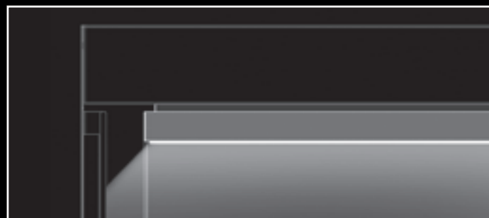
Vertikální řez světelným stropem LD8-LED Funkční schéma přímé osvětlení LED neutrální bílá
