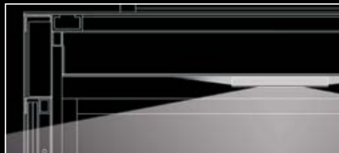
Vertikální řez LD7-LED-RGB stropní světlo Schema funkce: přímé a nepřímé osvětlení LED neutrální bílá
