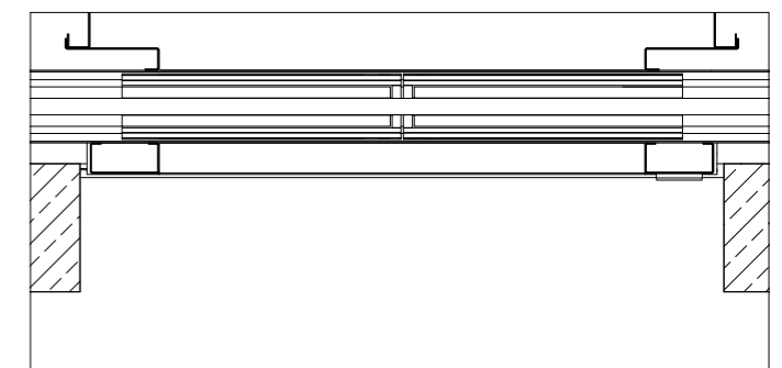
Horizontální řez kabinové a šachetní dveře s rámem dveří / napojením na zeď T1.
